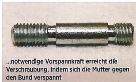
Bundschrauben und Bundbolzen (re.) kommen zum Einsatz, wenn die verschraubten Bauteile Bewegungsfreiheit brauchen. Die...
