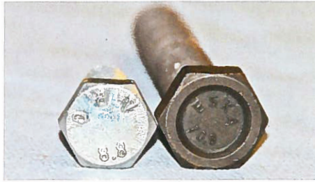
Eine 8.8er Güte ist im Kfz-Bereich üblich, an belasteten Verschraubungen (Bremsattel, Radaufhängungen) finden sich oft hochfeste Schrauben, die nicht gegen schwächere getauscht werden dürfen
