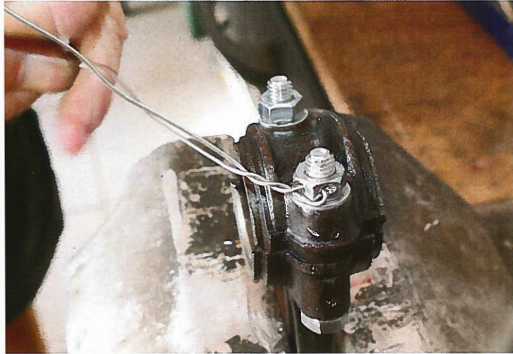
Gefühl gefragt: Die 1,5 bis 3 mm kleinen Löcher werden radial gebohrt
