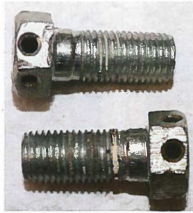
Bei hochfesten Schrauben (12.9) sollte man die Löcher in einer Dreherei machen lassen
