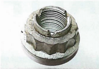
...populären Fehlgewindemuttern mit leicht abweichender Steigung auf den letzten Gewindegängen
