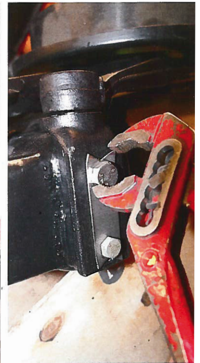
Simple Angelegenheit: Sicherungsbleche wie dieses lassen sich schnell selbst herstellen
