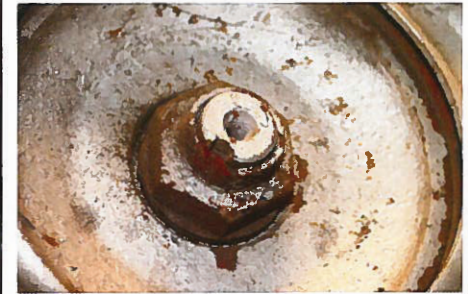
...Aufschrauben wird der Hals per Dorn oder Meißel in eine Nut auf der Welle eingestemmt
