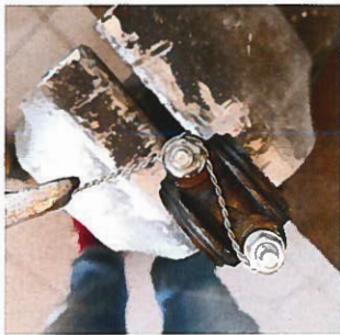
Wichtig: den Draht „auf Zug“ führen, also so, als würde er Schrauben oder Muttern festziehen!
