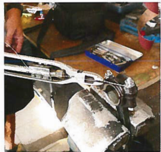
Eine Spindel lässt die arretierte Zange rotieren und verdrillt den Draht gleichmäßig
