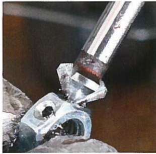
Zum Schutz des 0,5 bis 1,5 mm dünnen VA-Drahts werden die Bohrlöcher sauber entgratet
