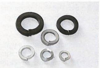
Früher üblich, inzwischen eher überholt: Wegen ihrer geringen Federkraft bieten Federringe keinen besonders guten Schutz gegen unbeabsichtigtes Losdrehen von Verschraubungen
