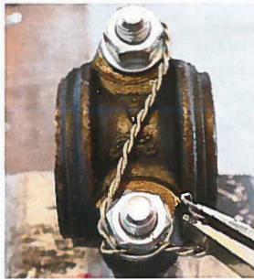
Nach ein paar Schlingen wird der Draht abgeschnitten und das Ende sauber beigelegt
