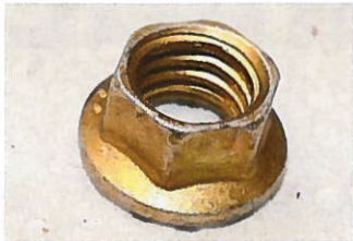
Bewusst leicht deformierte Muttern sind heute ebenso wenig mehr üblich wie die einst...
