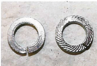
Früher üblich, inzwischen eher überholt: Wegen ihrer geringen Federkraft bieten Federringe keinen besonders guten Schutz gegen unbeabsichtigtes Losdrehen von Verschraubungen
