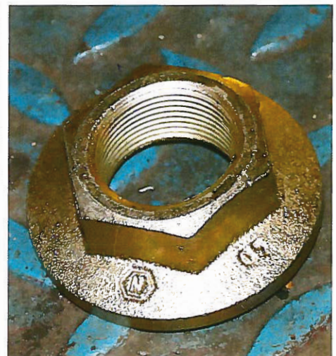
Statt Scheiben: Es gibt auch Muttern und Schrauben mit extrabreiten Auflageflächen
