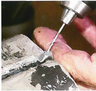
Gefühl gefragt: Die 1,5 bis 3 mm kleinen Löcher werden radial gebohrt
